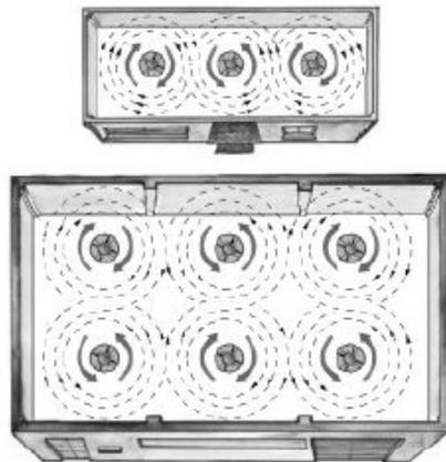
Směr otáčení první jednotky není důležitý, pokud směr otáčení následující jednotky bude opačný; není důležité, jakým směrem se bude otáčet poslední jednotka.
