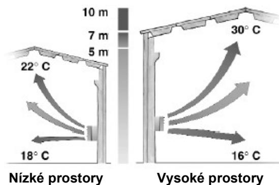
Tepelné ztráty stavebními prvky a spotřeba topné energie se tím značně ovlivňují, zejména když střešní konstrukce nedisponuje vhodnou tepelnou izolací s úplným utěsněním, jak tomu často bývá u starých průmyslových budov.
