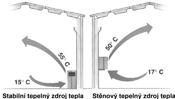
Takto vyrobené teplo se musí rovnoměrně rozdělit v prostoru. Rozdělení tepla ale bezesporu představuje největší problém konvenčního topení, protože jak již bylo zjištěno, nejteplejší vzduch má snahu stoupat nahoru a tím způsobuje dříve prokázané plýtvání energií. Tento jev však mimoto zabraňuje zaručit příslušný komfort v pobytové zóně.
