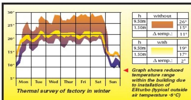
**Graf ukazuje redukovaný rozsah teplot uvnitř budovy v zimě z důvodu instalace Eliturbo<sup>®</sup> (teplota venkovního vzduchu -5°C, žluté-světlé pole zobrazuje rozdíl teplot s využitím systému Eliturbo<sup>®</sup> a hnědé-tmavé pole zobrazuje rozdíl teplot bez využití systému Eliturbo<sup>®</sup>).**
