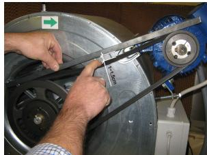
Položte dokonale rovně taženou tyč na obě řemenice, prstem zatlačte lehce doprostřed řemene a změřte vzdálenost mezi nejnižším bodem průhybu řemene a tyčí. Tato vzdálenost by měla být v rozmezí  $1 \div 1,5$  cm.
